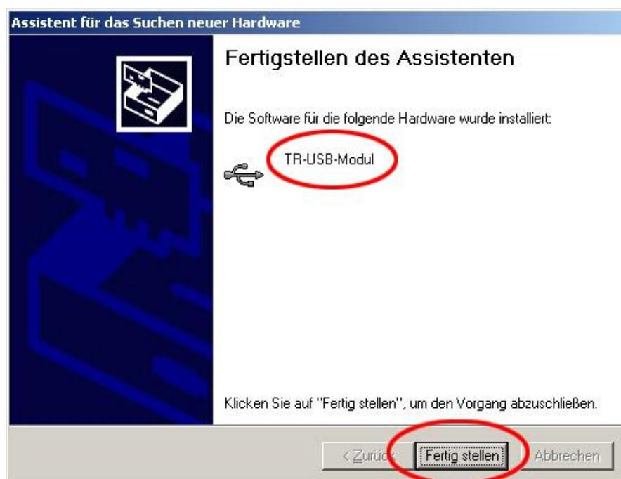
Danach wird der *Assistent für das Suchen neuer Hardware* für den **Serial Port** erneut gestartet. Wenn dies nicht der Fall ist, muss im **WINDOWS®**-Gerätemanager für den COM-Port „**TR-Serial-Adapter**“ der Treiber nochmals manuell installiert werden. Die Vorgehensweise ist jeweils die gleiche wie zuvor. Nach Abschluss der Installation ist der PC-Adapter funktionsfähig.
